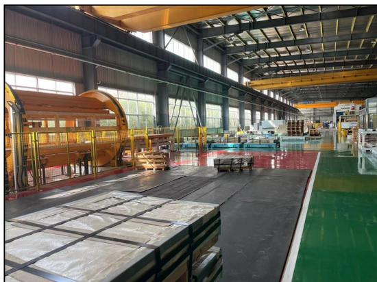
图 4.2-1#1#厂房冷轧车间南侧地面防腐防渗
